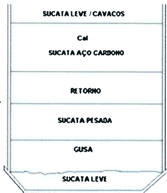
Figura 2- Montagem do primeiro carregamento de sucata [6].
